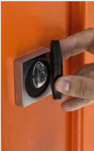
LETTORE DEL TRASPONDER ESTERNO L'apertura avviene attraverso l'avvicinamento del trasponder al lettore montato sulla porta. External transponder reader The door is opened by approaching the transponder to the reader fitted to the door.
