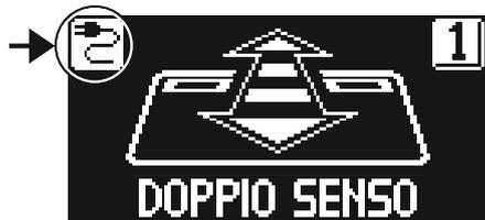
Presenza di alimentazione di rete e batteria collegata in stato di carica.
