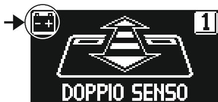
Assenza di alimentazione di rete e funzionamento della porta con batteria carica.
