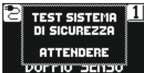
Quando si esce dal programma BLOCCO NOTTE o MANUALE per tornare al programma automatico, l'operatore effettua il test del sistema di sicurezza.
