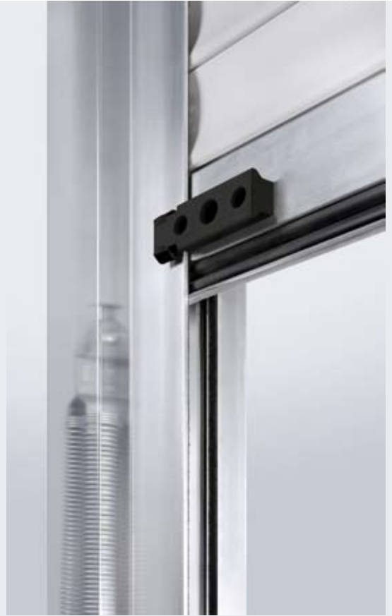
Tecnica con doppia molla a trazione e guida in alluminio con listelli di scorrimento interni in materiale sintetico e guarnizioni a spazzola
