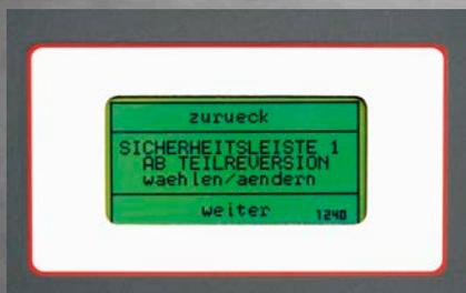
2x porta per collegamento di **OSE, 8,2 kΩ** o **interruttore a impulso di pressione**. Tutti i collegamenti vengono analizzati in modo separato. L'analisi può essere associata a qualsiasi senso di marcia. All'attivazione del dispositivo di sicurezza è possibile associare liberamente le risposte "Inversione parziale / totale" e "Stop".
