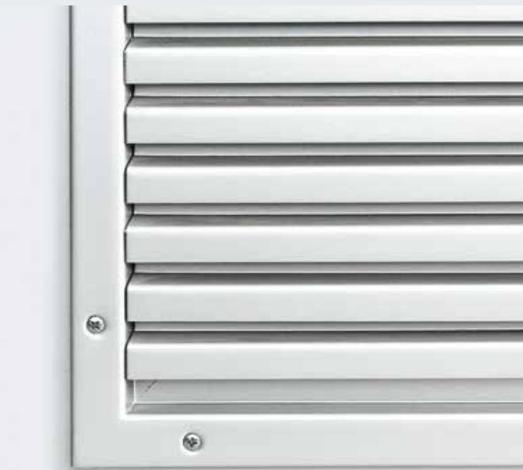
Tutte le griglie di aerazione sono costituite da lamiera d'acciaio a prova di sfondamento con interposta lamiera forata all'interno. Sono fornite zincate e con mano di fondo a polveri tonalità bianco grigio (simile a RAL 9002).
