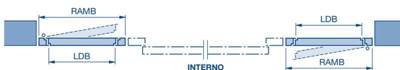
Montaggio in luce con apertura verso l'esterno o verso l'interno, DIN destra o DIN sinistra
